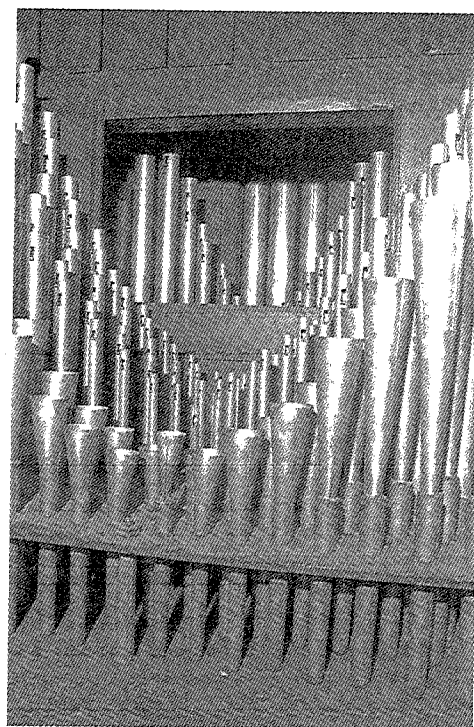
Tuyauterie du récit, dessus, et accès à la tuyauterie du grand- orgue, au-dessous des volets de la boîte expressive.
